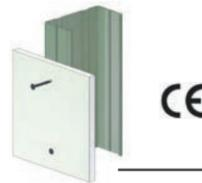
— Anwendungshinweis: Gipsplatte auf Metallständer (bis 0,7 mm Profilstärke)
