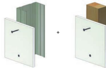
Faserplatte auf Metallständer (bis 0,7 mm Profilstärke)
