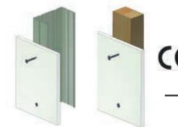
— Anwendungshinweis: Faserplatte auf Metallständer (bis 0,7 mm Profilstärke)
