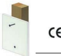
— Anwendungshinweis: Gipsplatte auf Holzunterkonstruktion
