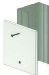
Gipsplatte auf Metallständer (0,8 mm bis 2,3 mm Profilstärke)
