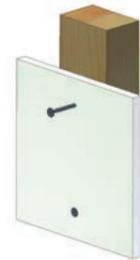
Gipsplatte auf Holzunterkonstruktion
