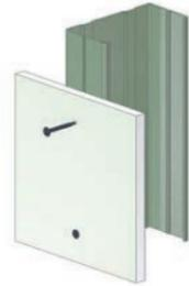
Gipsplatte auf Metallständer (bis 0,7 mm Profilstärke)
