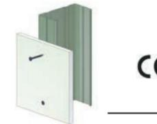
— Anwendungshinweis: Gipsplatte auf Metallständer (0,8 mm bis 2,3 mm Profilstärke)
